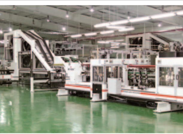
Em cima: Destaque tecnológico da nova linha de sacos de papel na Kumpoong Co. Ltd. – a coladeira de válvula CNC AD 8330.
